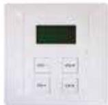
**Controlador de canal y volumen.** Selección de hasta 99 canales programables y control de volumen (0-9). Instalado en la zona local y conectado al sistema por bus, provee a la zona de selección de fuente, control de volumen. Bus: RS-485 con una distancia máxima de conexión de 1.200 metros. Conector de 4 polos (terminal block). Selector de canal DIP. Función de autobloqueo. Display LCD de 2x8 caracteres. Dimensiones: 86 x 56 x 40 mm. Material ABS. Color blanco.
