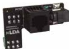
**Agrupador de ZES22.** Este dispositivo permite adaptar el bus ACSI típico del NEO a un ZES22 cambiando los PIN del cable UTP. Permitirá la conexión remota de MPS8Z.
