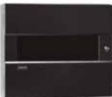
**Caja de ampliación de hasta 8 lazos mediante tarjetas de ampliación de 2 lazos (TBUD-250) para centrales modulares analógicas CAD-250.** Dispone de 2 salidas de sirenas supervisadas y 2 salidas de relés libres de tensión en placa. Salida auxiliar de 24 V 500 mA. Incluye fuente de alimentación con capacidad para 2 baterías BTD-1224 no incluidas. Dimensiones: 533 x 453 x 212 mm.
